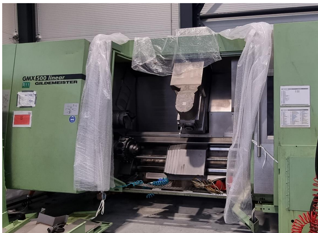
CNC-Dreh-Fräszentrum mit Haupt- und Gegenspindel zur effizienten 4-achsigen Komplettbearbeitung von Futter-, Stangen- oder Wellenteilen
